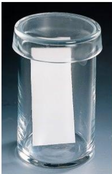
Przykład komory chromatograficznej z umieszczoną w niej płytką TLC
